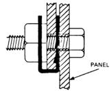
RECOMMENDED ASSEMBLY USING U NUT RETAINER 90-07786-00
