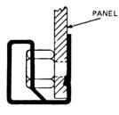
NOT-RECOMMENDED ASSEMBLY USING U NUT RETAINER 90-07786-01
