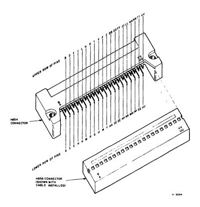
Figure 1 J1 or J2 Connector Pin Locations
