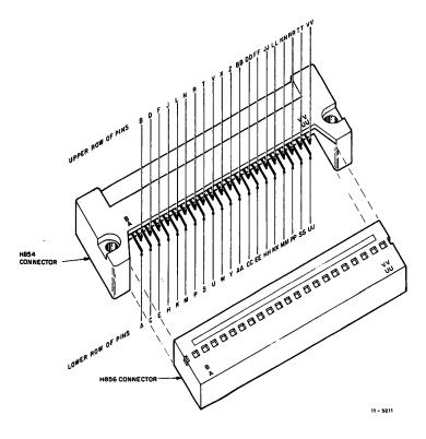
Figure 8 J1 or J2 Connector Pin Locations
